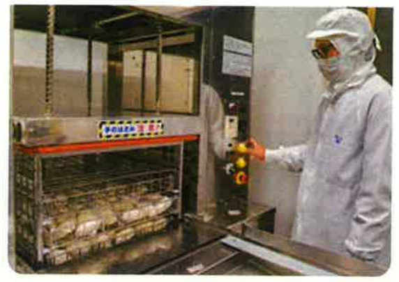
マイナス30℃のフローズン液に浸けることで通常の凍結機の20倍の速さで凍結できる。
