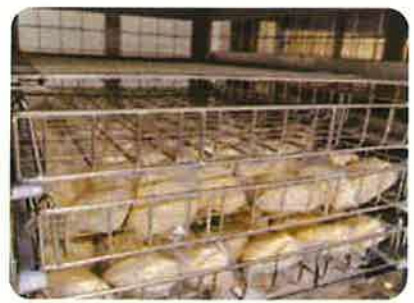
マイナス30℃のフローズン液に浸けることで通常の凍結機の20倍の速さで凍結できる。
