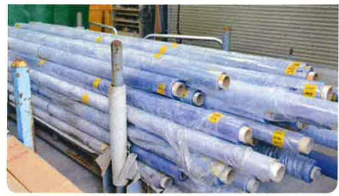
溶着加工される前の材料。現在はほとんどのビニールハウスでポリフィルムが使われている。
