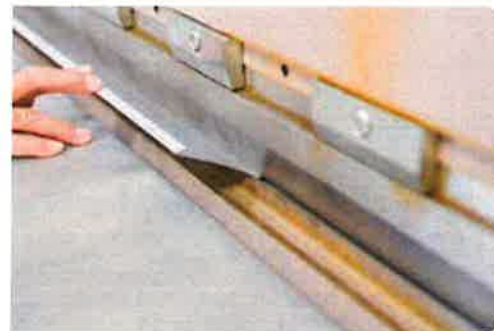
切断後の板を折り曲げる「動力折曲機」。最新機能により高精度な折りを実現している。
