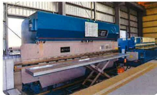
「動力切断機」。板幅300mmまでならどんな長さの板でも切断できる。
