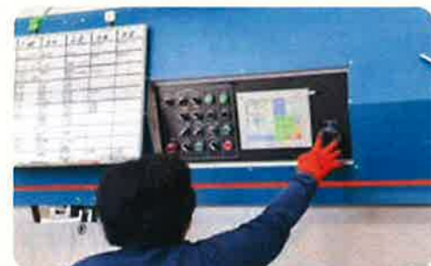
二つの機械共にパネルモニターによる全自動制御。
