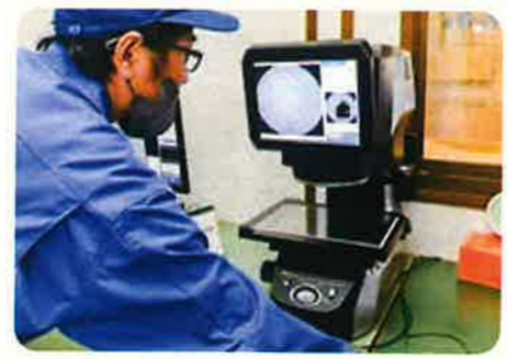
対応するプログラムを呼び出して製品を置くだけ。誰が扱っても同じ測定結果になる。
