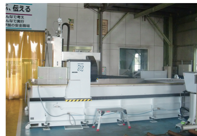
設置したアプレシブジェットカッター
