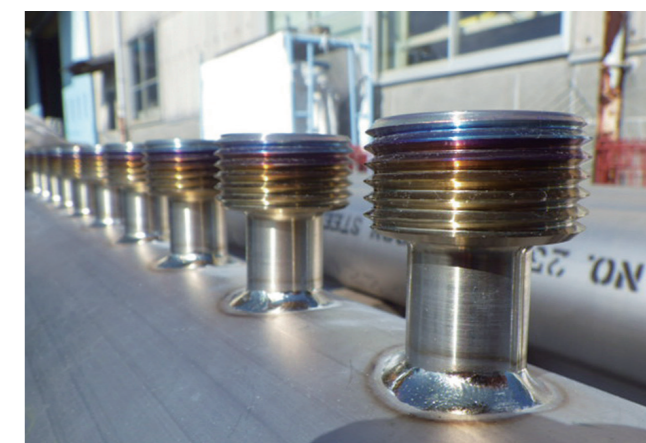
開孔部に溶接加工されたチタン製ノズル
