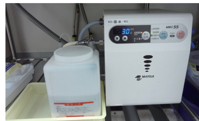
電解次亜水生成装置
