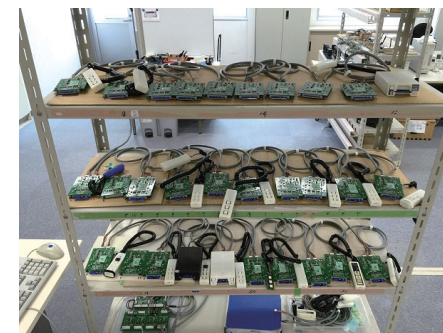
試作端末30台を接続しての性能評価試験
