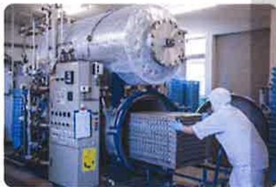
新たに導入した殺菌装置はデジタル方式で圧力を制御するため、加熱時のムラがなくなり、商品の品質が向上しました。
