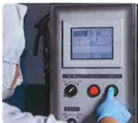
中でた野菜を真空冷却装置にセッティング およそ10分で10℃まで冷却されます。
