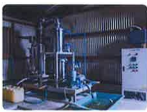
窯から発生する煙を液化した後、蒸留されます。
