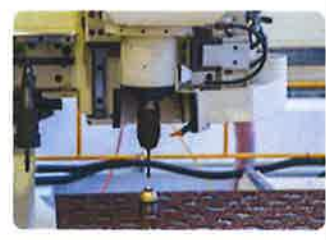
手作業で行わざるを得なかったネジ加工が精密な機械作業になったことで、一定の品質が確保できるようになりました。
