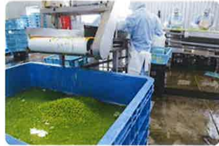
ゆでられた枝豆をわずか3分で急速冷凍する冷凍機。鮮度が損なわれません。
