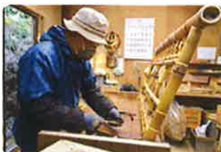
長椅子が仕上がるまではおよそ2週間、割れに細心の注意を払いながら竹を組み立てています。
