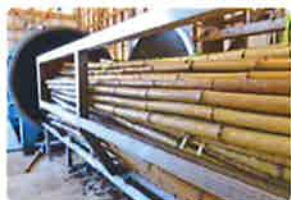
湯煎・殺菌し、乾燥させた真竹に竹材真空注入装置を使って薬剤を注入。防虫加工を行います。
