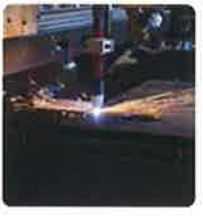
プラズマ自動切断機導入以前の平均切厚に比べ、短い時間で高精度の加工ができるようになりました。
