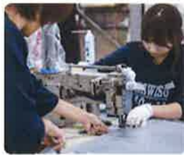
二人一組で行うミシン作業。四方を補強レタクを取り付けます。長さ50メートルものシートを製作することもあります。
