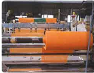
裁断機に自動巻き取り装置を増設することで作業時間が半分以上に短縮しました。
