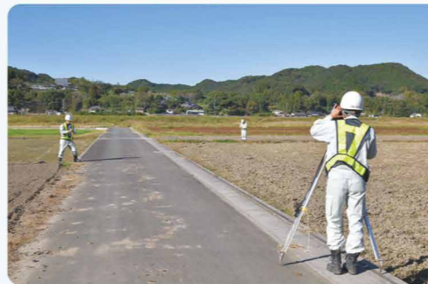
従来の機器を使った測量作業。 3名以上の人員が必要でした。
