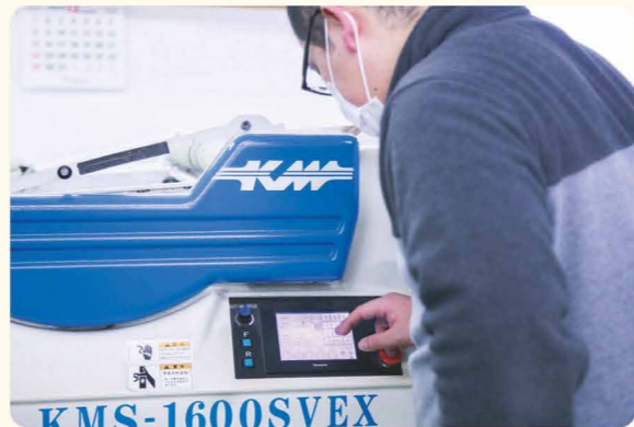
反物から生地を自動で引き出して所定の長さにカットする全自動延反機。
