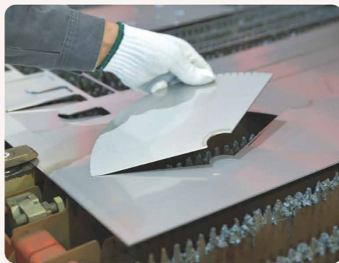
加工を終えた板は自動で排出。同時に次の板が加工機に供給されます。
