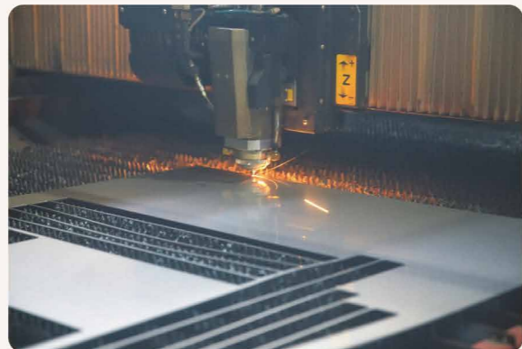
パレットチェンジャーからレーザー加工機に供給された鉄板。
