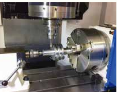
高速回転する刃物の 動作にNC円テーブル が連動することで同 時4軸加工を実現して います。
