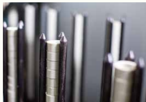
これから加工する材料を多数ストックできるワークストッカーを内蔵しています。
