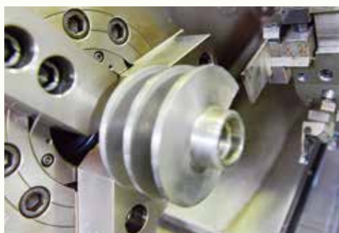
以前スパイラル部品の製造に使われていたNC旋盤。 加工する溝が深くなると刃物のピリピリが発生して、 うまく加工することができませんでした。
