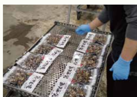
真空包装した鶏炭火焼をレトルト殺菌装置にセット。レトルト処理のみの外注も受けています。
