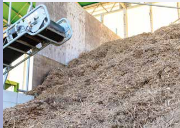
木チップふるい分け設備にかけられた後のバイオマス発電用チップ。
