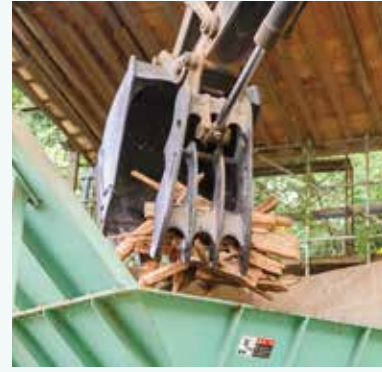
搬入されてきた木くずをそのまま投入できるのが木くず粗破砕機の何よりの強みです。
