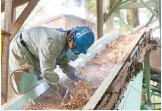
搬入されてきた木くずをそのまま投入できるのが木くず粗破砕機の何よりの強みです。
