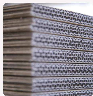
糊付けの精度が上がり、ずれがほとんどなくなったことで張り直しの作業も不要になりました。
