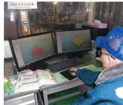
機械シミュレーションソフトを使用した 3次元CAD/CAMデータの読み込み
