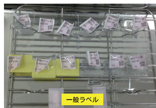
数分で粘着剤が溶剤に溶け、剥がれる
